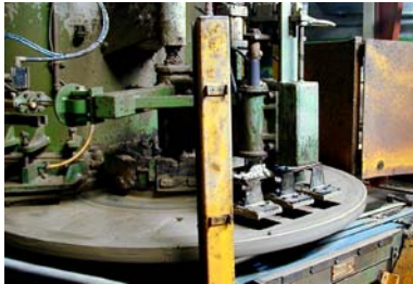
Figur 19. Blødstrygningsmaskine. Bemærk de tre stempler, der presser de våde sten ud af "formene". Vedstaarup Teglværk
