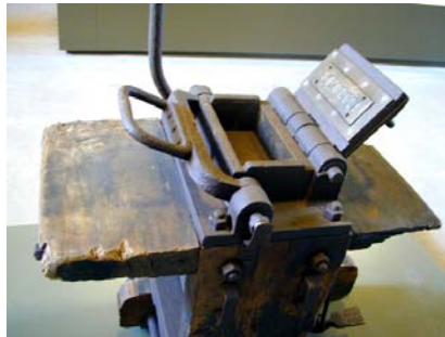
Figur 10. Detalje af efterpresse af træ og jern fremstillet af et lokalt værksted til Rendbjerg Teglværk. Teglværksejer Dithmers navnestempel er skruet fast til låget i formen. Cathrinesminde Teglværksmuseum.
