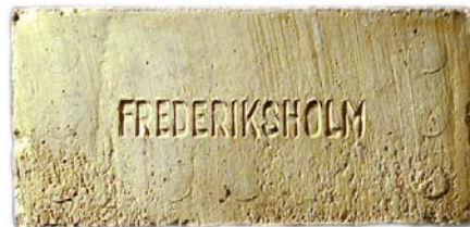
Figur 20. Blødstrøgen sten med stempel på den ene af de brede flader. Nivågård Teglværksmuseum
