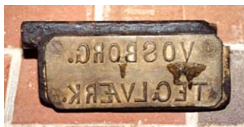
Figur 17. Stempelplade af støbt metal skruet på en træplade med 4 skruer. Skærum Mølle Teglværksmuseum
