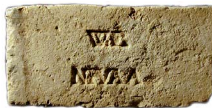
Figur 6. Håndstrøgen sten med stemplet W.E. NIVAA for Waldemar Engelsted, Nivågård Teglværk 1847-1857. Nivaagaard Teglværks Ringovn
