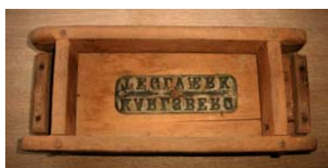
Figur 7. Form til klapsten fra Carlsberg Teglværk Foto: Jan Rømsgaard
