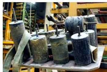
Figur 18. Ruller til prægning af mønster i stenenes sider. Vedstaarup Teglværk.
