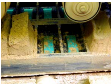
Figur 21. Maskine til "håndstrøgne" sten. En afmålt mængde ler kastes ned i formen. Matzens Teglværk.
