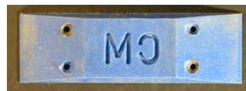
Figur 22. Formen er i bunden forsynet med en matrice CM for Carl Matzen. Matzens Teglværk
